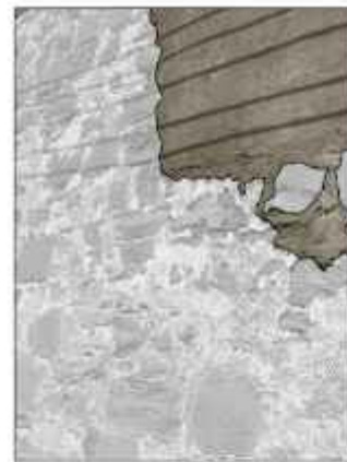
1. Επικάλυψη τοιχοποιίας με στρώση σκυροδέματος
